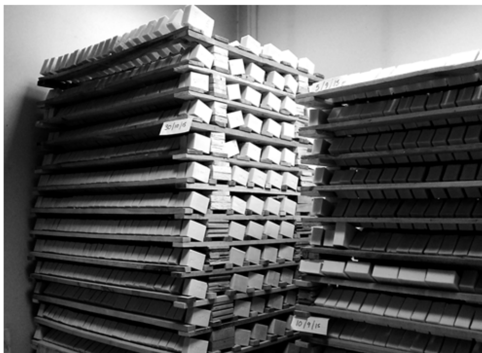
Salonico (Grecia), stabilimento Vio.Me - Essiccazione dei saponi in ambiente climatizzato
